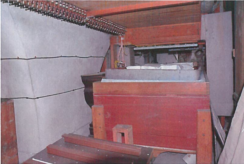
Vargonų vidaus su dumplėmis ir elektriniu oro pūstuvu fragmentas.
