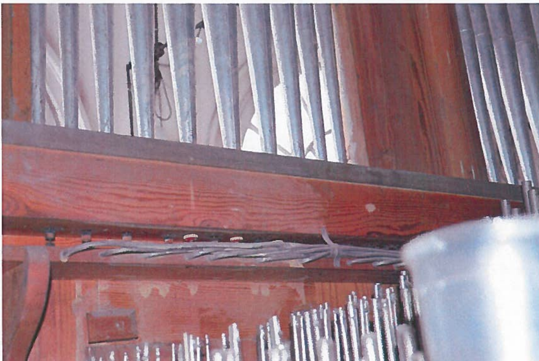
Fasadinių vamzdžių oro skirstymo dėžės ir jos pneumatinės traktūros fragmentas.
