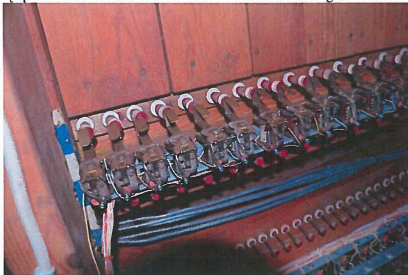
Oro dėžių apatinės dalies su ~1975 m. sumontuotomis elektromagnetinėmis relėmis fragmentas.
