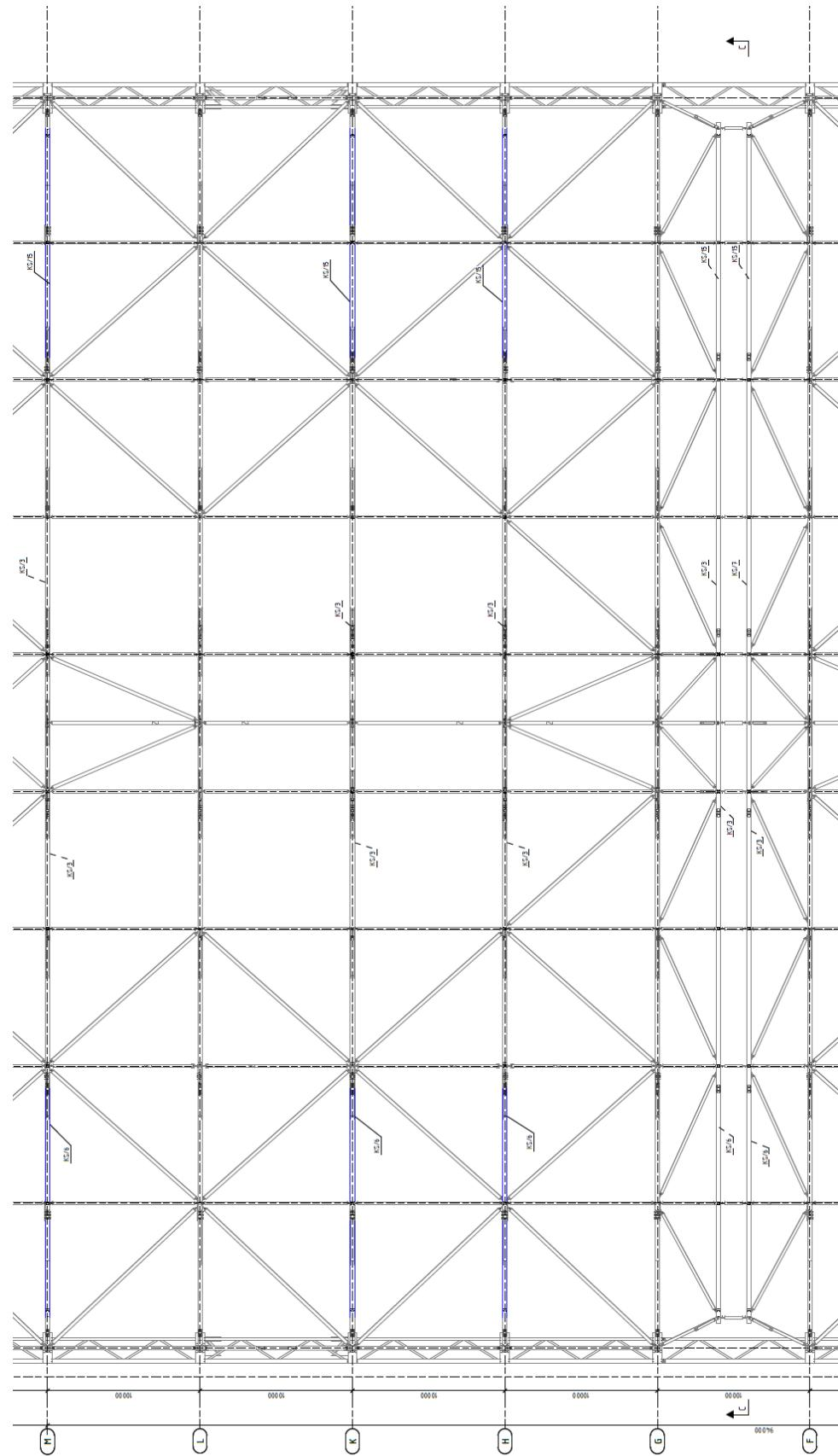
**Stogo sijo santvaros ryšių sistema (pvz) ašys „M“-„F“ / Roof beam truss connection system axles „M“-„F“:**
