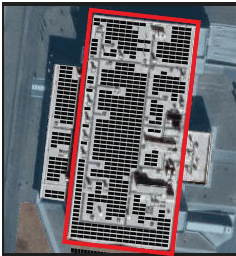
12 pav. Planuojama saulės modulių išdėstymo schema
