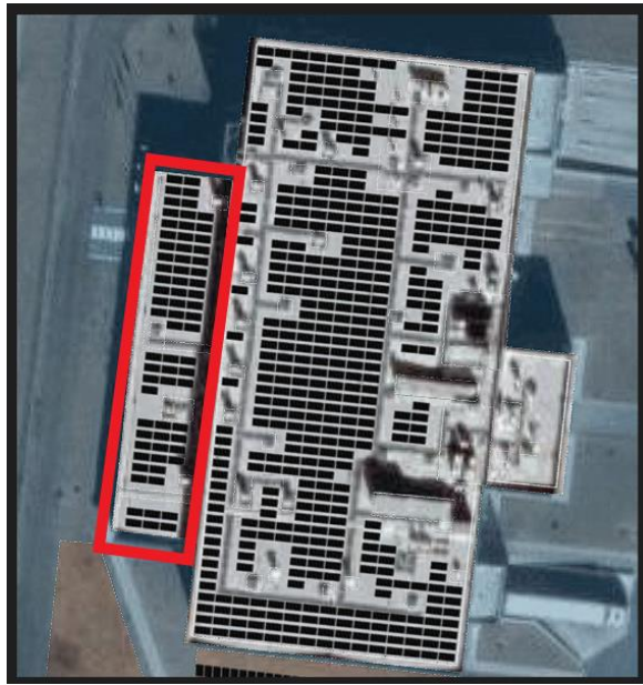
18 pav. Planuojama saulės modulių išdėstymo schema
