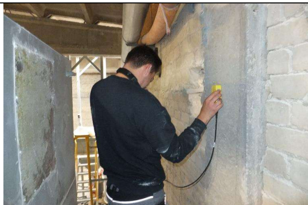
15 pav. Neardomu būdu išmatuota vidurinės kolonos armatūra.
