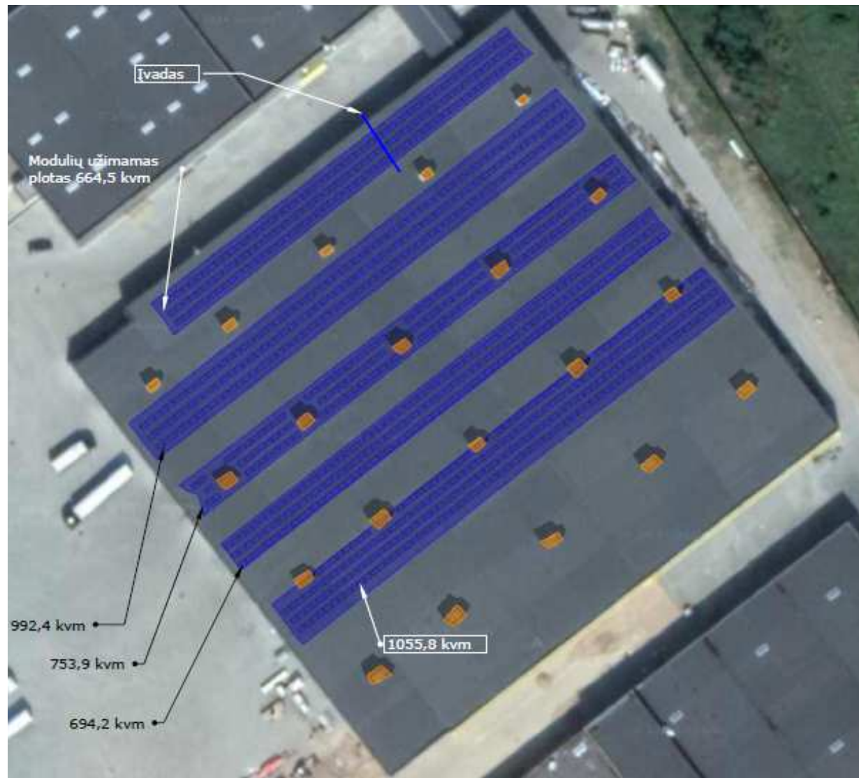
Fotomodulių išdėstymas ant pastato stogo, Ryternos g.2, Biruliškės, Kauno r., planas
